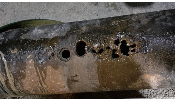
写真－2 漏水箇所 (1967竣工DCIP φ350mm)
